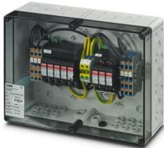
Generatoranschlusskasten für Photovoltaikanlagen bis 1000 V DC zum Anschluss von 3x 2 Strings. Mit Überspannungsschutz (Typ 1/2) und Kabelverschraubungen für die Eingangs- und Ausgangsseite.
