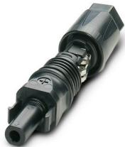
Photovoltaik-Steckverbinder, Artikelfamilie: SUNCLIX, Farbe: schwarz, Polzahl: 1, Aderquerschnitt min.: 2,5 mm<sup>2</sup>, Aderquerschnitt max.: 6 mm<sup>2</sup>, Bemessungsspannung: 1100 V DC, Bemessungsstrom: 35 A, Anschlussart: Federkraft, Kontaktart: Buchse, Kabeldurchmesser min.: 5,5 mm, Kabeldurchmesser max.: 8 mm, Nachfolgeartikel von 1774674
